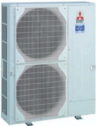
Кондиционер **CoolTegPlusDX** может быть подключен к одному наружному компрессорно-конденсаторному блоку, оснащенному всеми управляющими элементами (компрессор, расширительный вентиль, частотный преобразователь). В наружных блоках применяется компрессор, работающий на хладагенте R410A.
