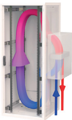
Циркуляция воздуха в шкафу, оснащённом кондиционером CoolSpot CW WW
