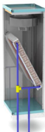
Кондиционер является безкомпрессорным и подключается к трубопроводам с охлажденной (чиллерной) водой. Избытки тепла из охлаждаемого помещения передаются через теплообменник охлажденной воде, которая, в свою очередь, охлаждается чиллером.
