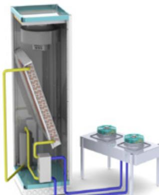
В кондиционер встроен водоохлаждаемый конденсатор, к которому подводятся трубопроводы от внешнего охладителя. Избытки тепла из охлаждаемого помещения передаются фреоновым, затем водяным (этилен / пропилен гликоловым) контурами к внешнему охладителю и рассеиваются во внешнюю среду.
