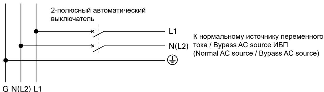
Не используйте автоматические дифференциальные выключатели RCD/ELCB 30 мА на входе в ИБП.
