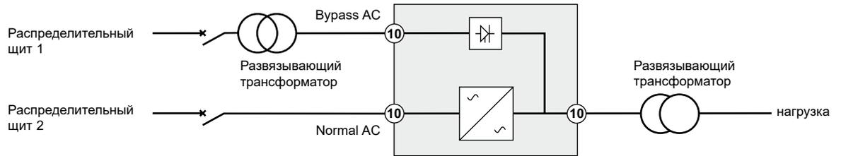
**ИБП с трансформаторами гальваноразвязки**
