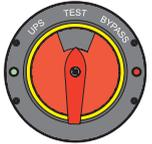
1. Переведите оба ИБП в "**Internal Bypass mode**" (Режим внутреннего байпаса, см. руководство пользователя ИБП)
