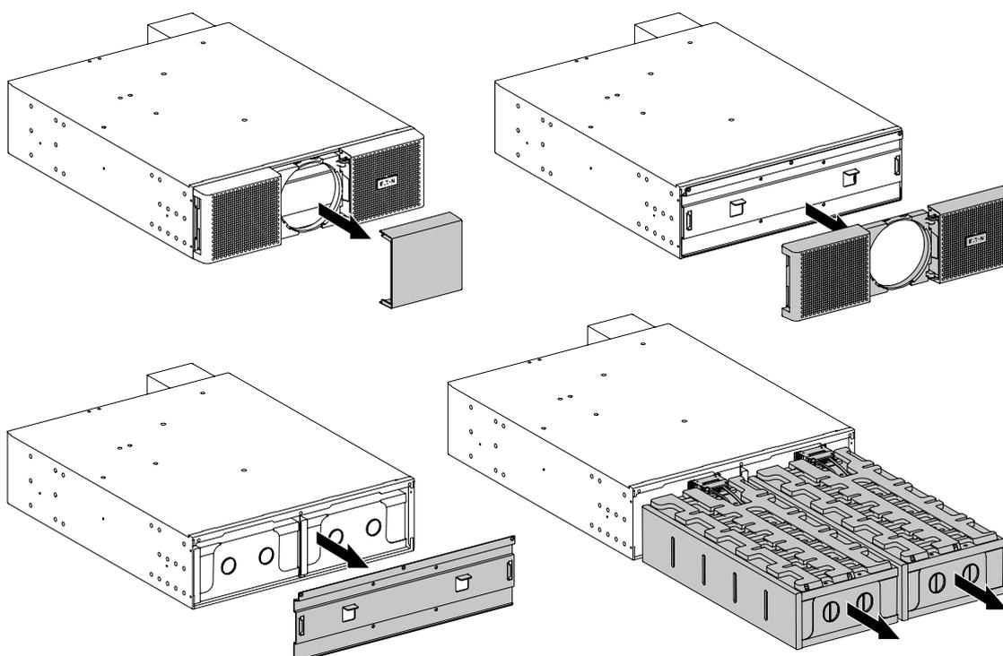
4. Выньте пластиковую ручку из левой и правой аккумуляторной батареи, и медленно перемещайте батареи по ровной и устойчивой поверхности. Используйте две руки для поддержки аккумуляторных батарей. Положите их в стороне для установки после того, как ЕВМ будет горизонтально установлен.
