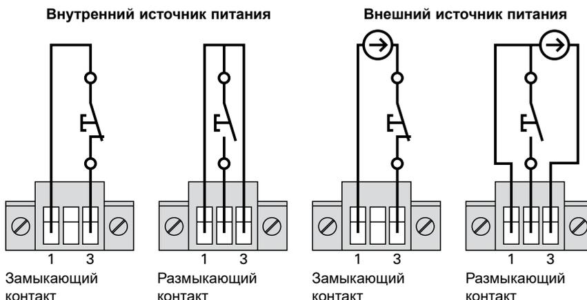
Номинальный размер провода клеммы равен 0,32-4 мм<sup>2</sup> (22-12 AWG).
