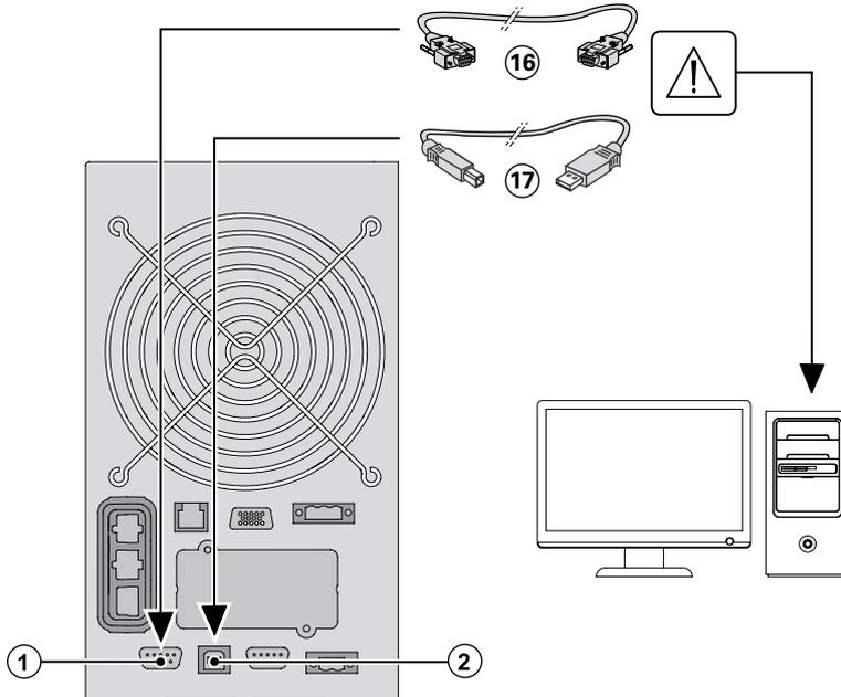
1. Подсоединить кабель связи RS232 (16) или USB (17) к последовательному порту или порту USB компьютера.
