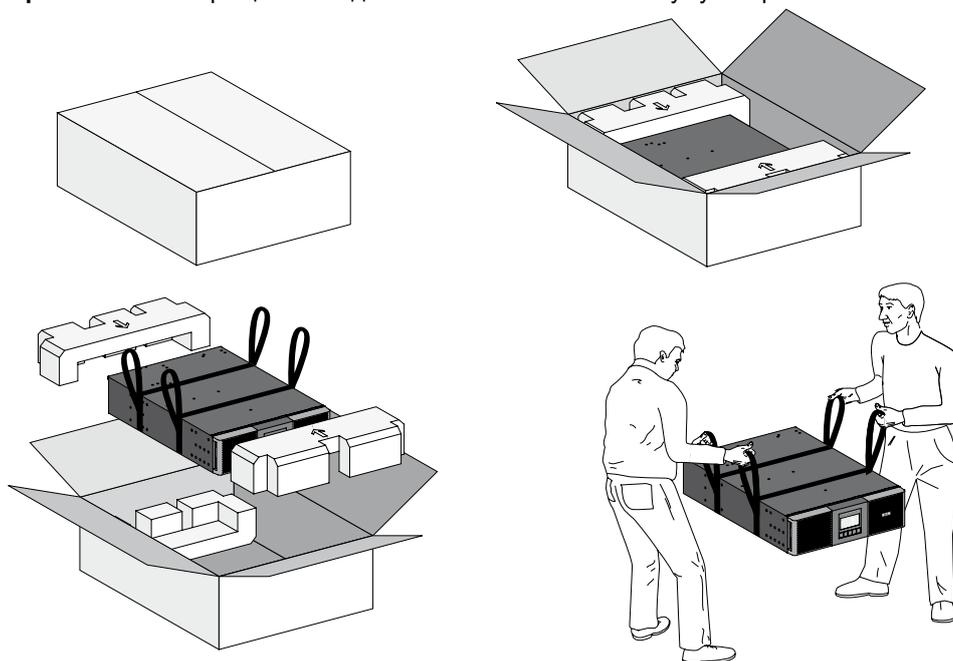
Распаковка ИБП и EBM.
