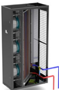
Кондиционер является безкомпрессорным и подключается к трубопроводам с охлажденной (чиллерной) водой. Избытки тепла из охлаждаемого помещения передаются через теплообменник охлажденной воде, которая, в свою очередь, охлаждается чиллером.
