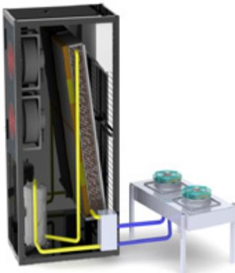
В кондиционер встроен водоохлаждаемый конденсатор, к которому подводятся трубопроводы от внешнего охладителя. Избытки тепла из охлаждаемого помещения передаются фреоновым, затем водным (этилен/пропилен гликоловым) контурами к внешнему охладителю и рассеиваются во внешнюю среду.
