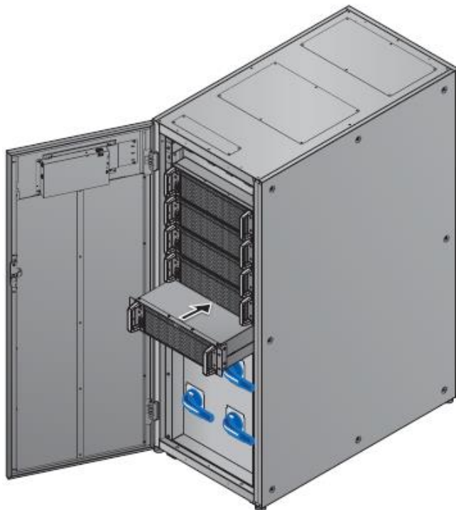
Рисунок 5-35: Установка модуля STS в ИБП
