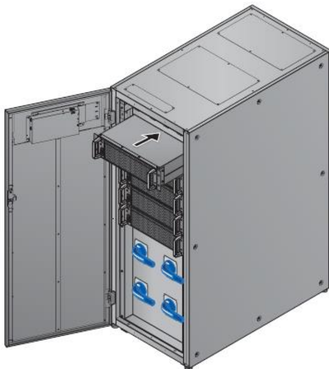
Рисунок 5-46: Установка силового модуля в ИБП
