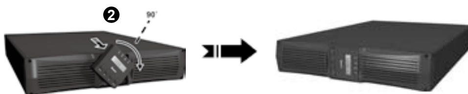
Рис. 3е. Перемещение ИБП в вертикальное положение
